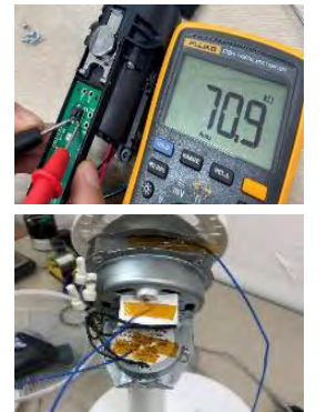
(상)소비전력 측정, (하)부품 온도 측정
