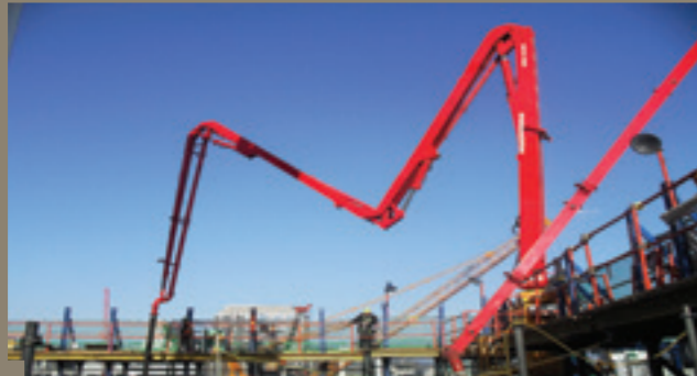
C.P.B(Concrete Placing Boom)
