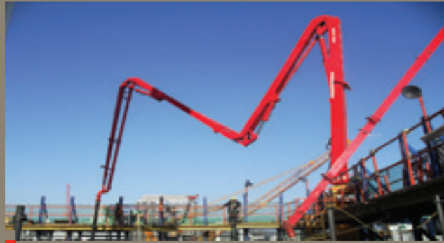
C.P.B.(Concrete Placing Boom)
