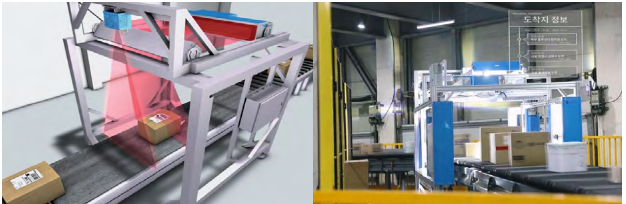
스마트물류 IPS(Image Processing System) : AI 기반 화물 이미지 인식 시스템
